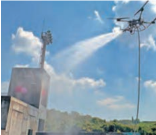
消防用ドローン
